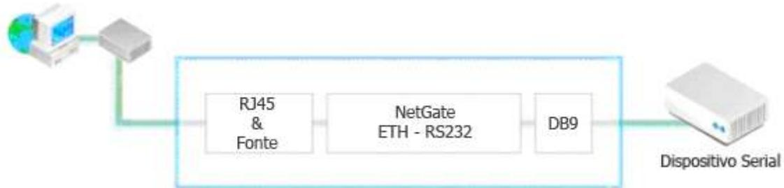
O equipamento NetGate DUO (ETH-2xRS232) é um conversor de protocolo que transmite os dados enviados pela serial do equipamento para a rede Ethernet TCP/IP e no sentido inverso transmite dados TCP/IP para a serial RS-232.
